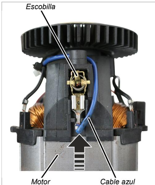
→ Insertar en la escobilla el cable azul del cable de conexión del motor.
