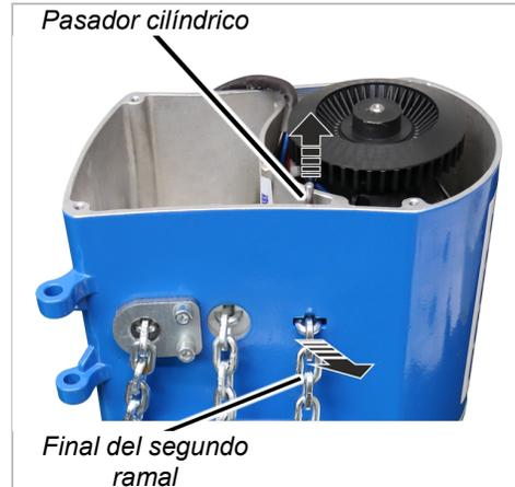
➔ Sujetar el final del segundo ramal y extraer el pasador.
