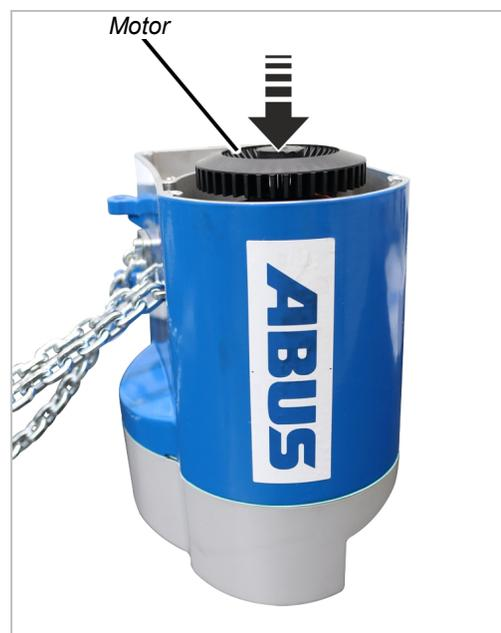
● El árbol del motor encaja con precisión en el piñón de plástico de la reductora.
