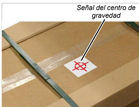
➔ Al cargar u descargar, observe la señal del centro de gravedad en la caja.
